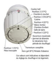
Une vanne thermostatique permet de maintenir automatiquement la température d'une pièce. En effet, à l'intérieur du bouton tournant est caché un mécanisme qui se dilate ou se contracte en fonction de la température ambiante – et du coup il ouvre ou referme l'arrivée d'eau chaude dans le radiateur.
